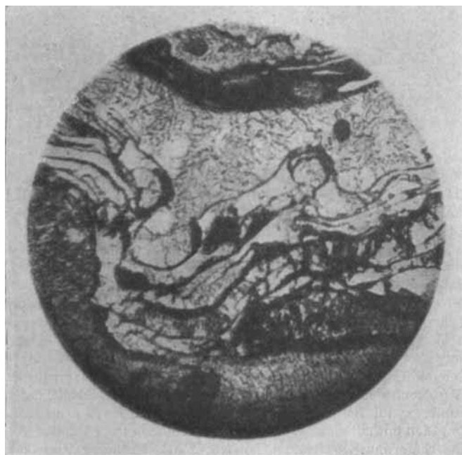
Abb. 16. Silberstahl, verspritzt, 1200 mal vergrößert. (Hardenit.)
